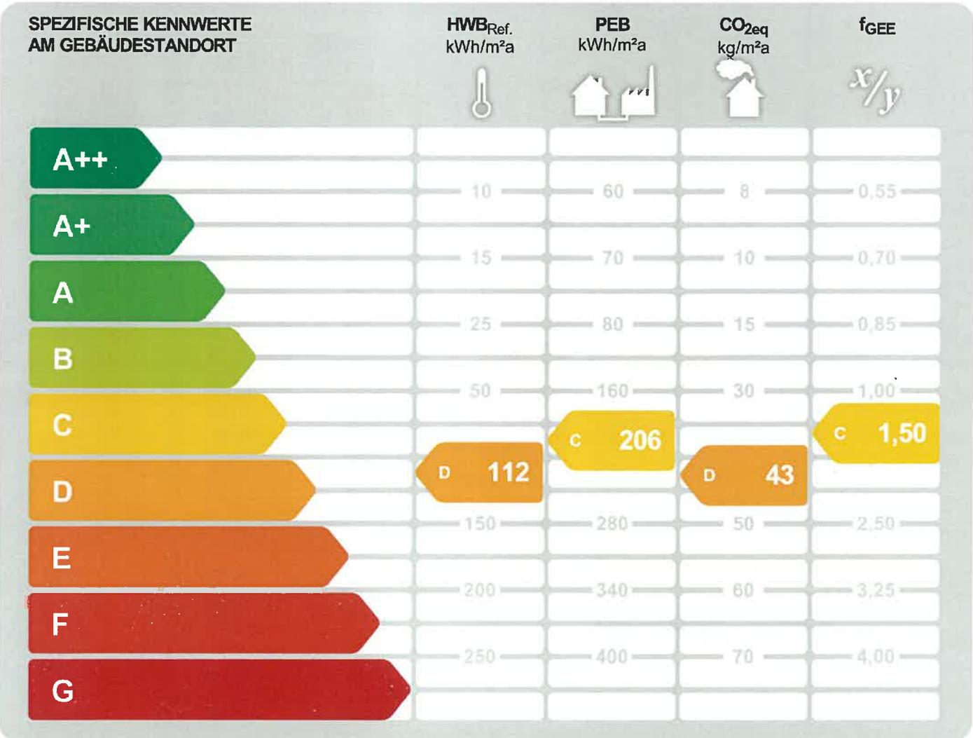
**HWB<sub>Ref.</sub>:** Der Referenz-Heizwärmebedarf ist jene Wärmemenge, die in den Räumen bereitgestellt werden muss, um diese auf einer normativ geforderten Raumtemperatur zu halten. Dabei werden etwaige Erträge aus Wärmerückgewinnung raumlufttechnischer Anlage nicht berücksichtigt.
